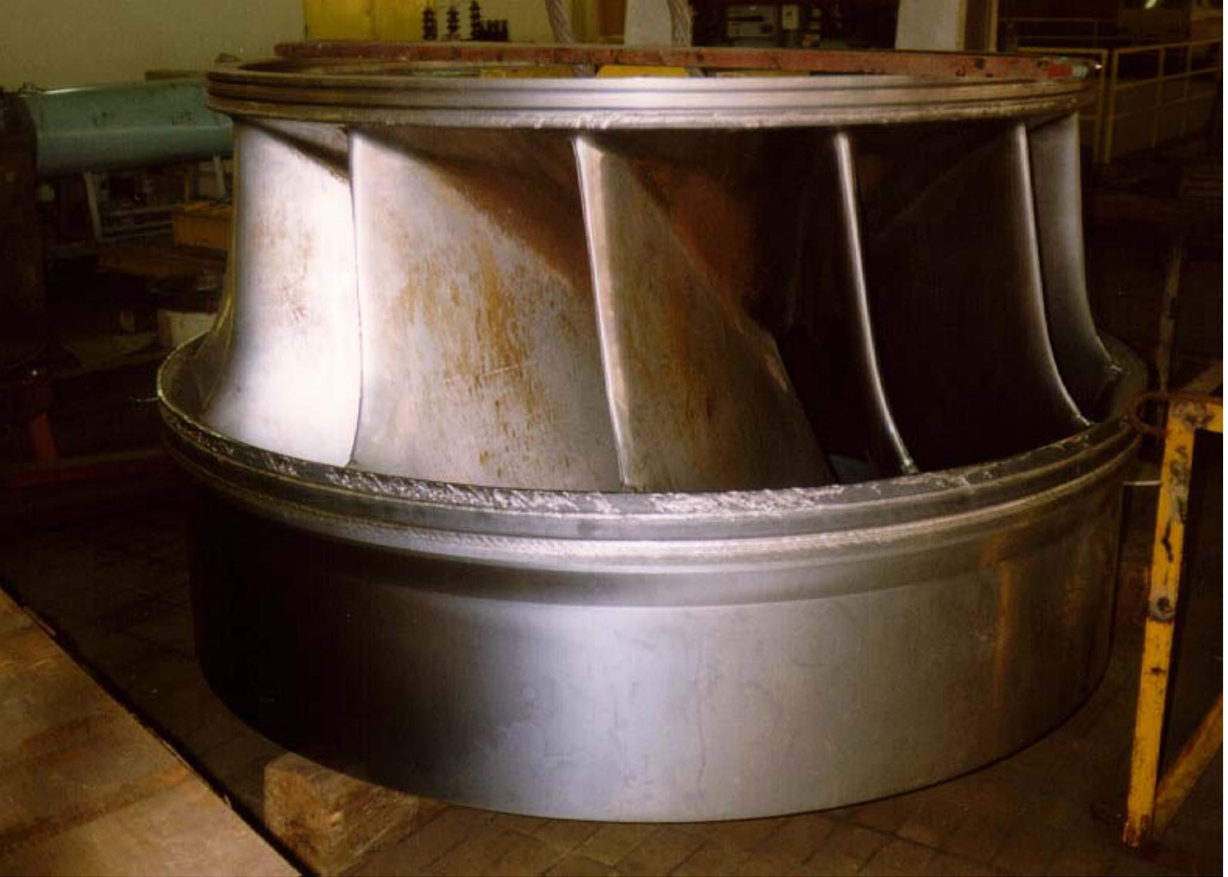
Lauftrad einer Francis-Turbine (23 MW) mit Erosionsschäden
