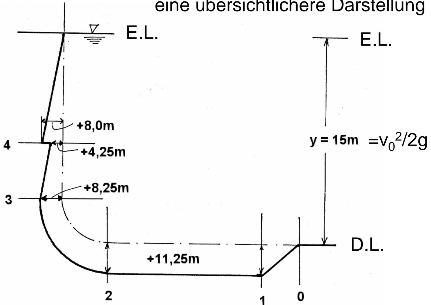
(Für die Stellen  $i = 1$  bis 4 ist  $v_i = \text{konst.}$  und die D.L. liegt um  $v_i^2/2g = 3,75\text{m}$  unter der E.L.)
