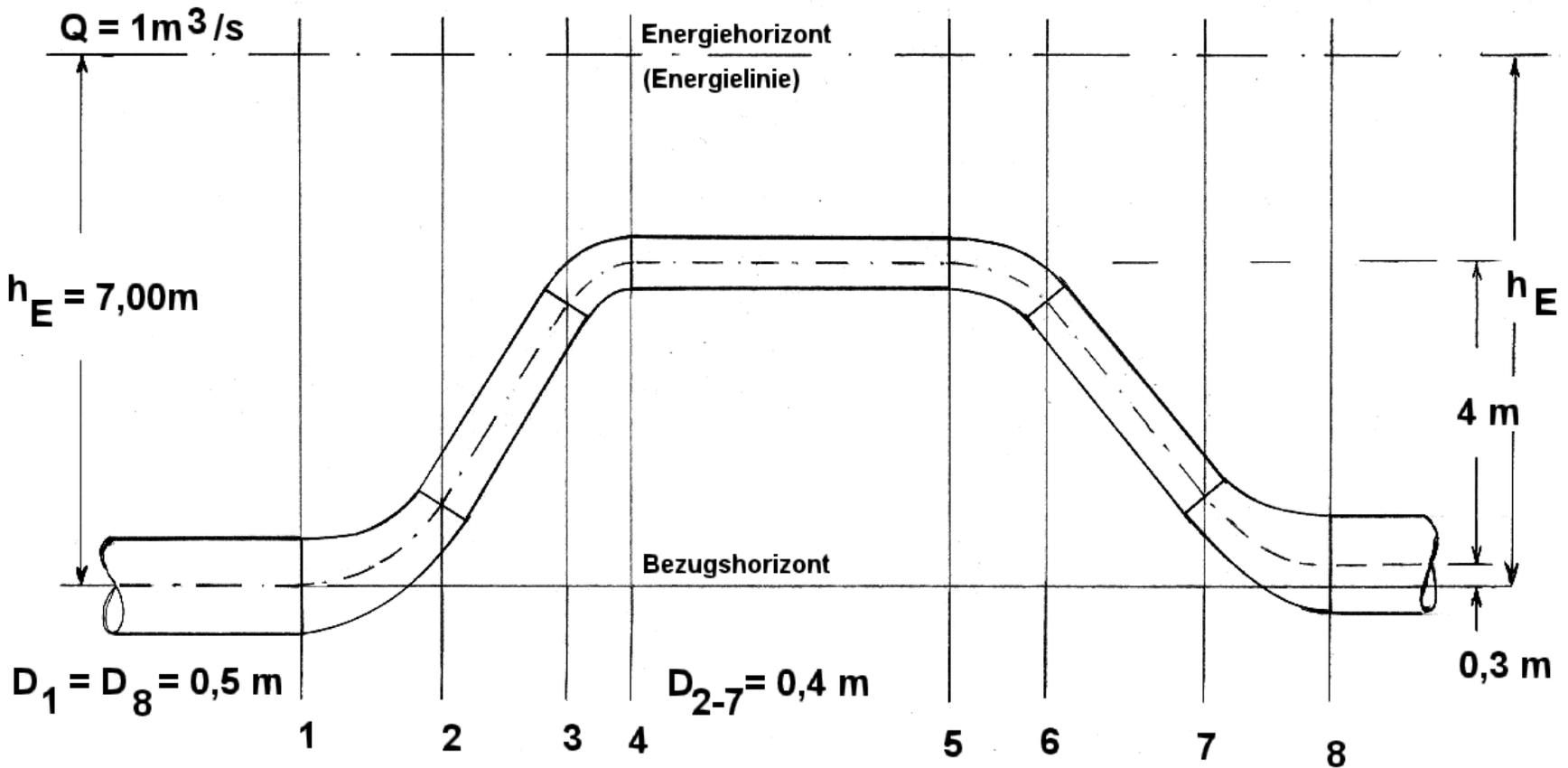
Aufgabe: Bei bekannter Energiehöhe  $h_E = 7\text{m}$  ist  $Q = 1\text{m}^3/\text{s}$ .
